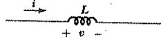
شكل 1 - 4 الاشارات المرجعية للفولتية والتيار مبنية على رمز الدائرة للمحثة v = L di/dt
